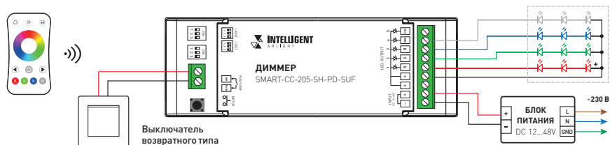
Рис. 2. Схема подключения диммера для управления RGBW-нагрузкой
