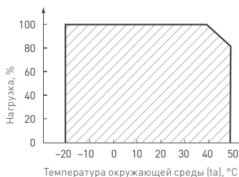
Рис. 3. Максимальная допустимая нагрузка, % от мощности источника
