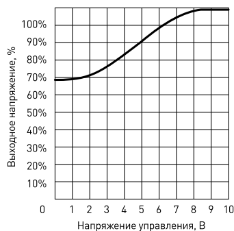
Изменение выходного напряжения от напряжения управления
