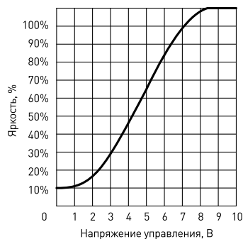
Яркость от напряжения управления (100%-нагрузка)
