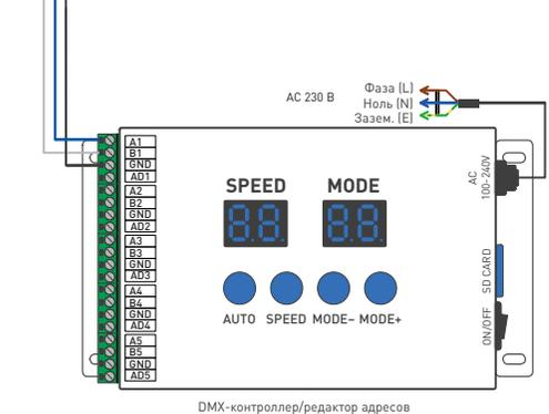
Схема 1. Подключение ленты с использованием контроллера с несколькими портами и с функцией редактирования адресов, а также с использованием раздельных блоков питания
